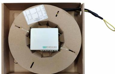
**Boîte de terminaison optique plate en plastique**, préconnectée des **deux côtés**, avec 4 prises SC/APC et tireur ; disponible avec **11-19 m** de câble à 4 fibres pour les installations multiservices **FTTH**; solution très utile pour amener tous les services centralisés dans le CSOE des installations FTTH à l'intérieur de chaque unité d'habitation individuelle. Il répond aux exigences de la classe **Cca** selon la **norme CPR EN 50575**.
